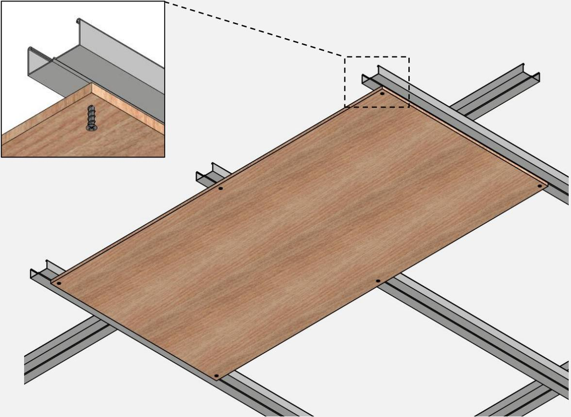
*Illustrasjonene viser plater med dimensjon 1200x600mm montert i profilsystem/stendere, med markert plassering for skruer.*
