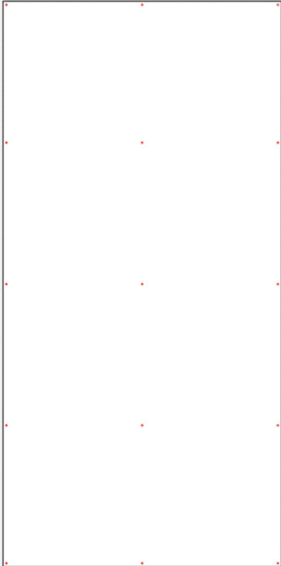
NB! Ved montering av plater med dimensjon 2400x1200mm (eller større) må de enten limes eller ha en ekstra rekke med skruer på midten.
