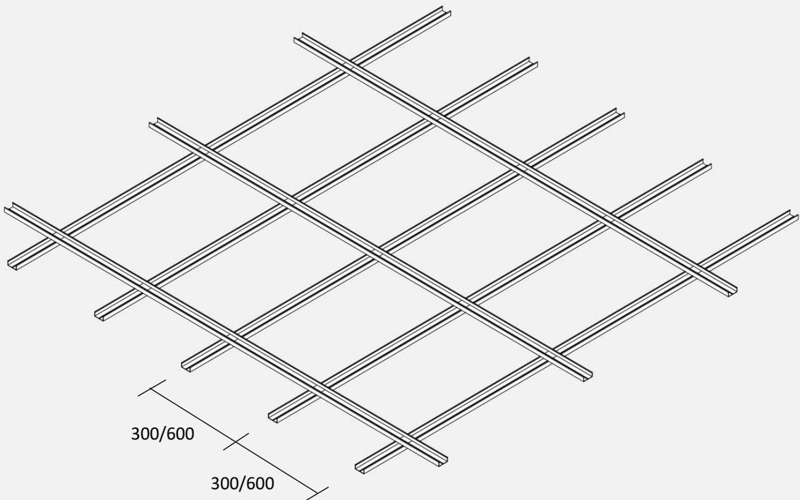
Vyrk sine finérte plater til himling er beregnet for montering i et profilsystem montert med 600mm senter-senter.
